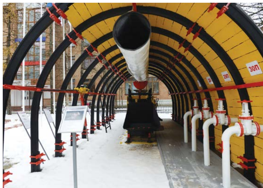
Учебный полигон в Ухте. Машина погрузочная шахтная, макет горной выработки
